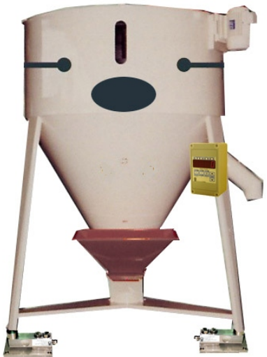
CELLA DI CARICO A COMPRESIONE COMPRESSION LOAD CELL
